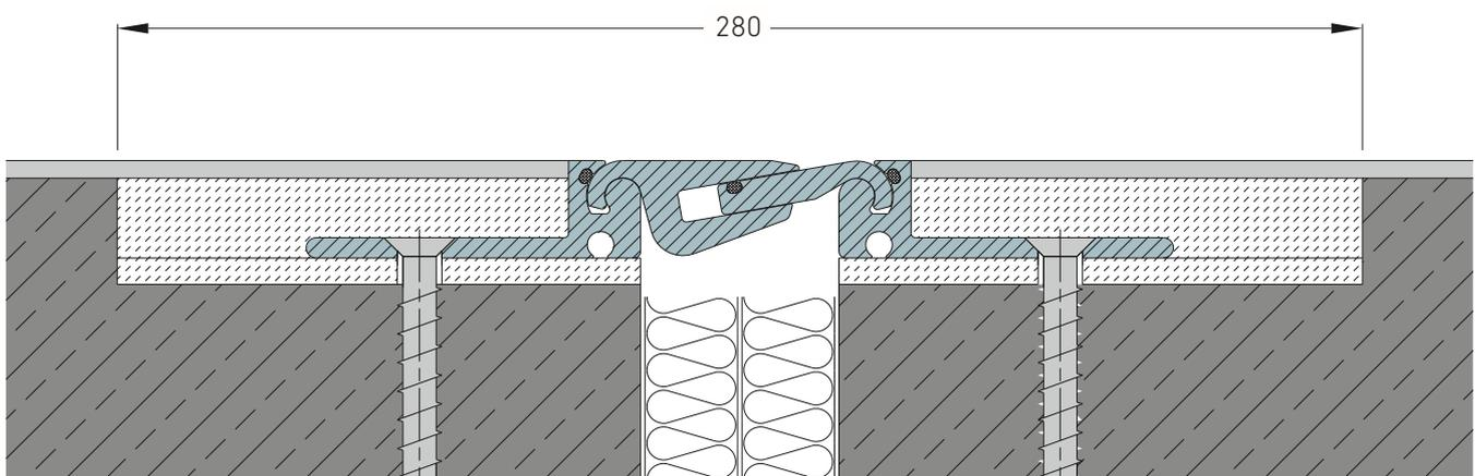
MIGUTRANS-Fugenkonstruktion in bauseits vorhandene Aussparung montiert Profil: FS 75/22
