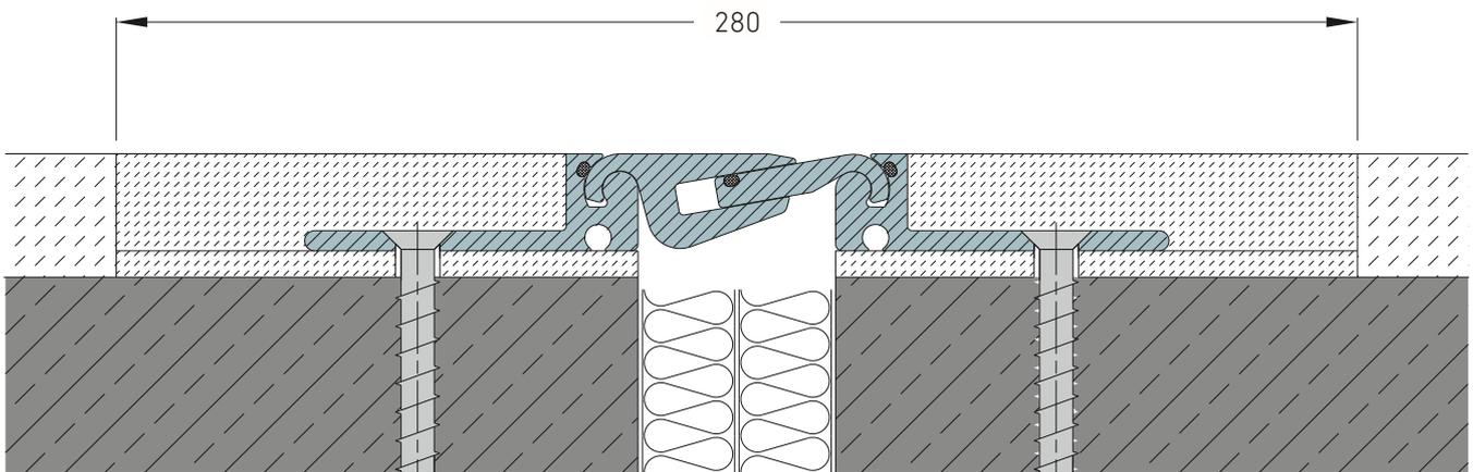
MIGUTRANS-Fugenkonstruktion z.B. in Verbindung mit Hartstoffestrich, Magnesitestrich Profil: FS 75/22
